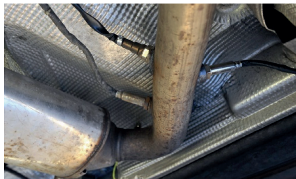
Het SEMS-systeem maakt gebruik van onder meer een of twee \text{NO}_x -sensoren en een \text{NH}_3 -sensor, die gemakkelijk zijn aan te brengen op de uitlaat van een voertuig.
