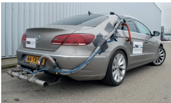
Een PEMS-systeem geïnstalleerd op een Euro 6 personenwagen.
